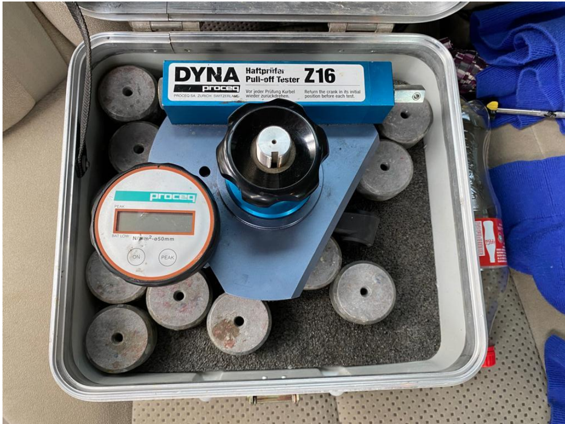
Figura 42: Equipo para el ensayo a tensión (Pull Off Tester)
