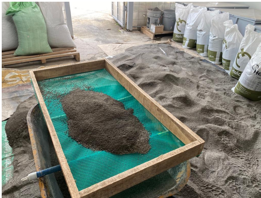
Figura 31: Tamizado de la arena
