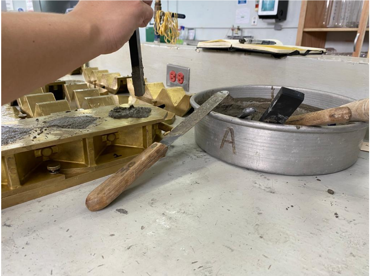
Figura 44: Moldeo de los especímenes cúbicos de mortero
