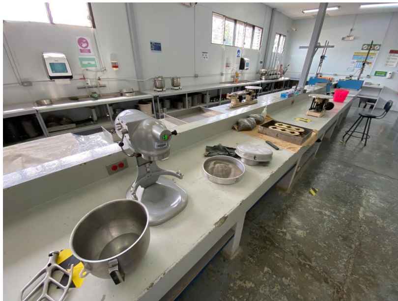
Figura 11: Equipo utilizado para el moldeo de especímenes de mortero según norma ASTM C109
