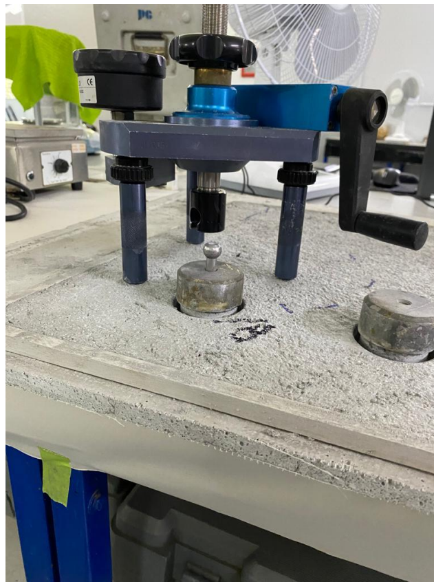
Figura 27: Equipo para la prueba Pull-Off (Pull-Off tester)
