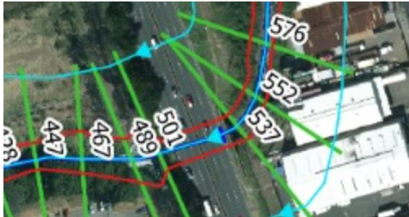
Figura 11.13. Proyección 537.19 y 501.06 de las secciones transversales antes y después de la alcantarilla.
