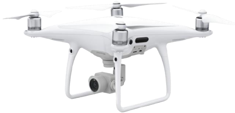
Figura 11.10. Equipo para levantamiento ortofotográfico, DJI, Phantom 4 pro v2 Fuente: Imagen de internet.
