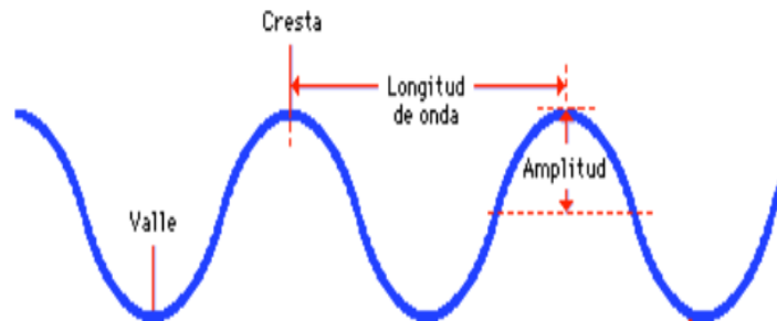
Figura 13. Ejemplo de una onda transversal Fuente: Corty, Rodríguez, Magallon, Lauterio y Tabares (2015).
