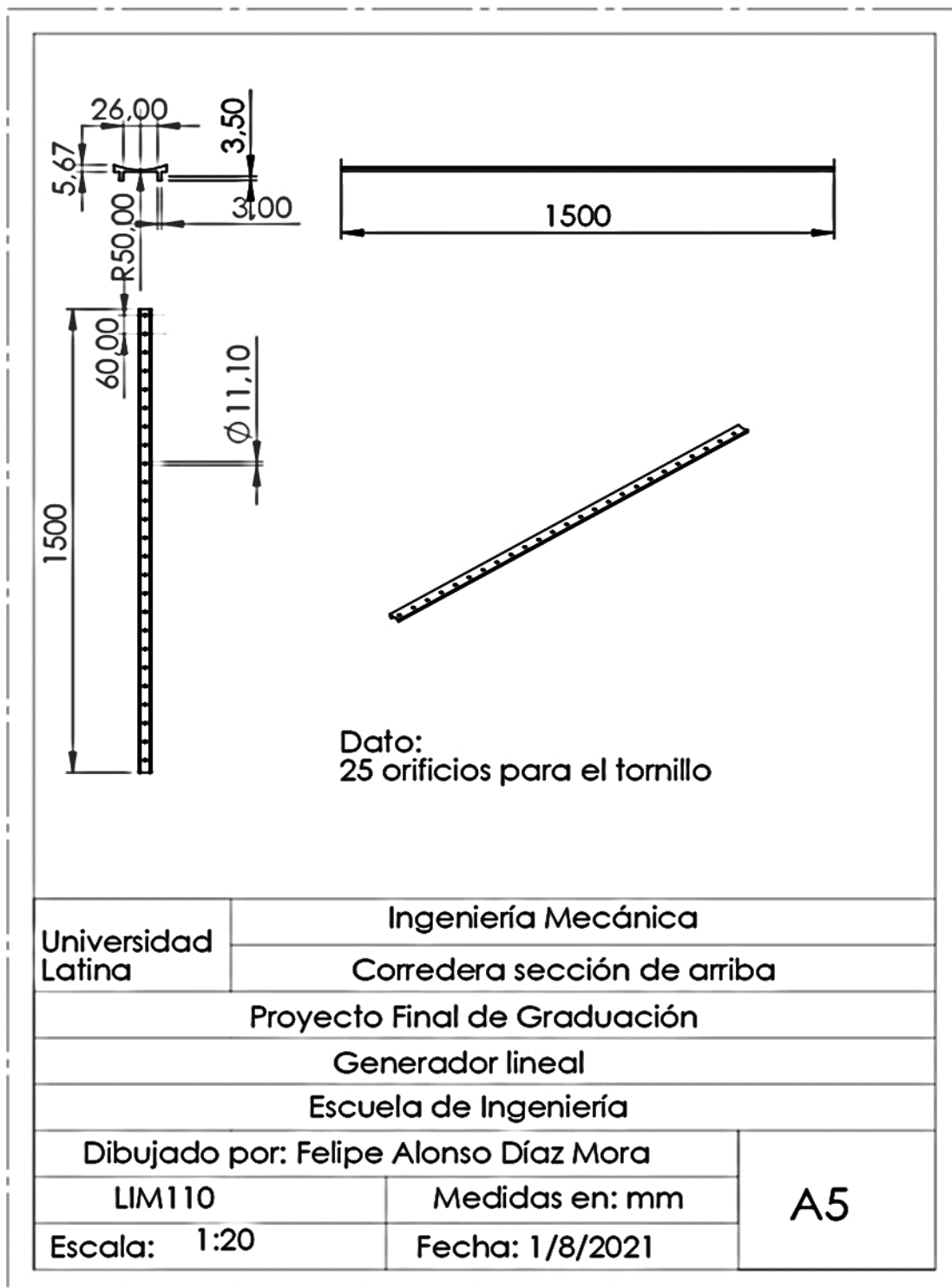
Figura 62. Plano de corredera parte superior. Fuente Elaboración propia.
