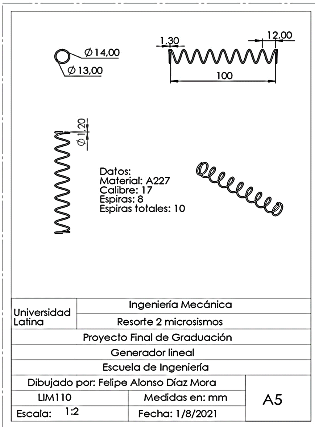
Figura 59. Plano del resorte 2 para microsismos. Fuente: Elaboración propia.
