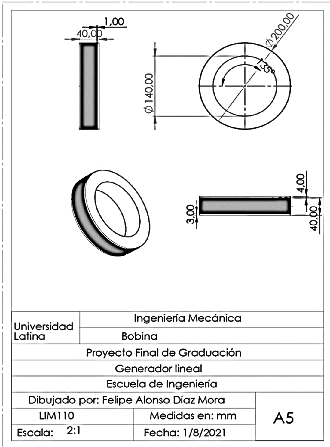
Figura 56. Plano de la bobina. Fuente Elaboración propia.
