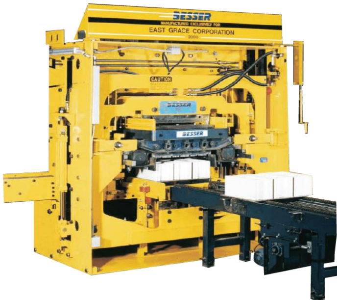
Figura 5 Máquina automática para la fabricación de bloques
