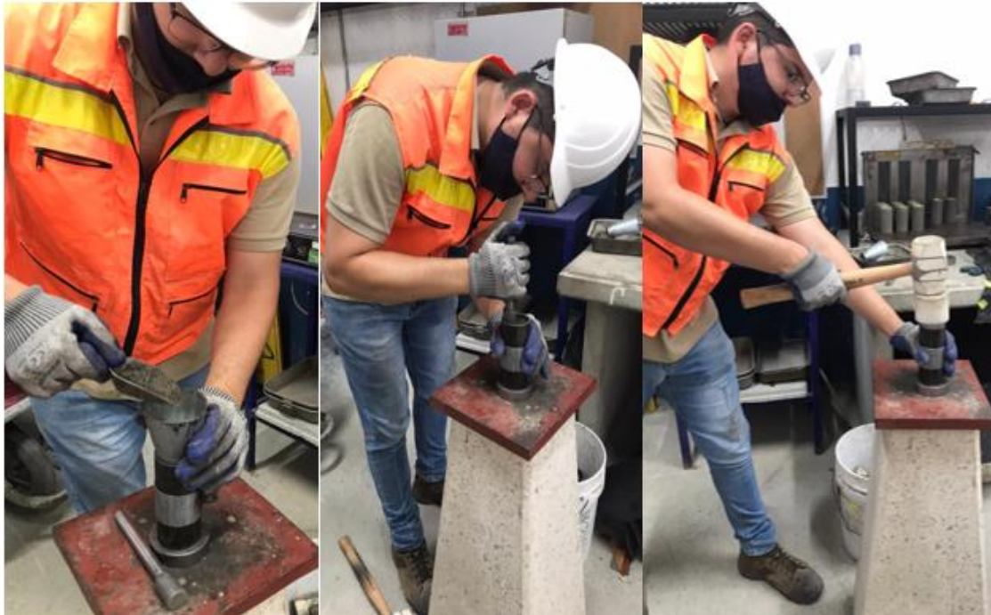
Figura 16 Moldeo de Especímenes por el Método de Frasson Jr.
