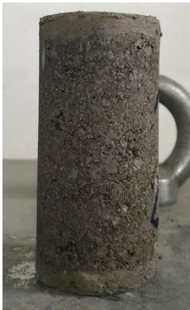
Figura 17 Especímen cilíndrico moldeado por el método de Frasson Jr.
