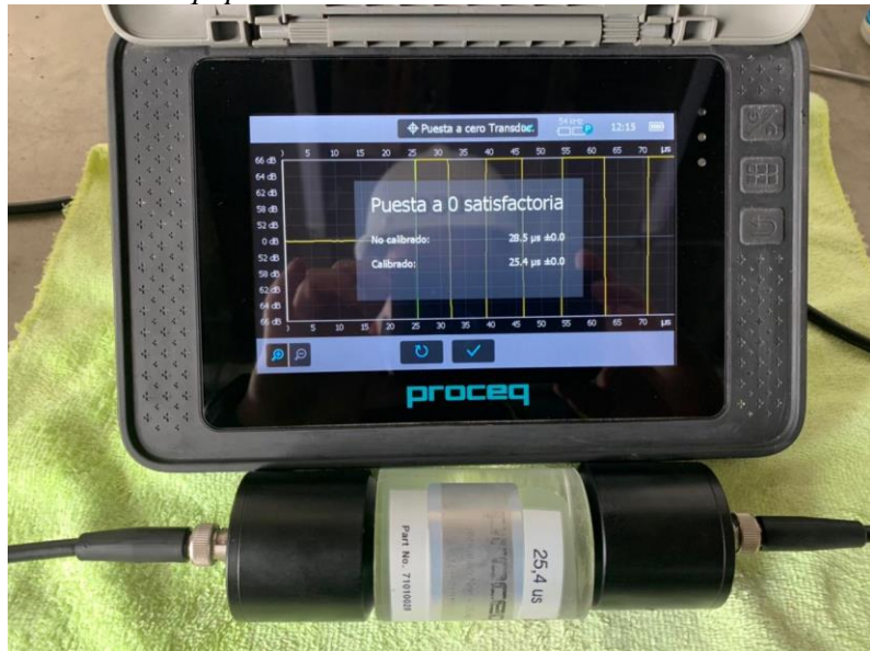
Figura 36 Calibración equipo de ultrasonido
