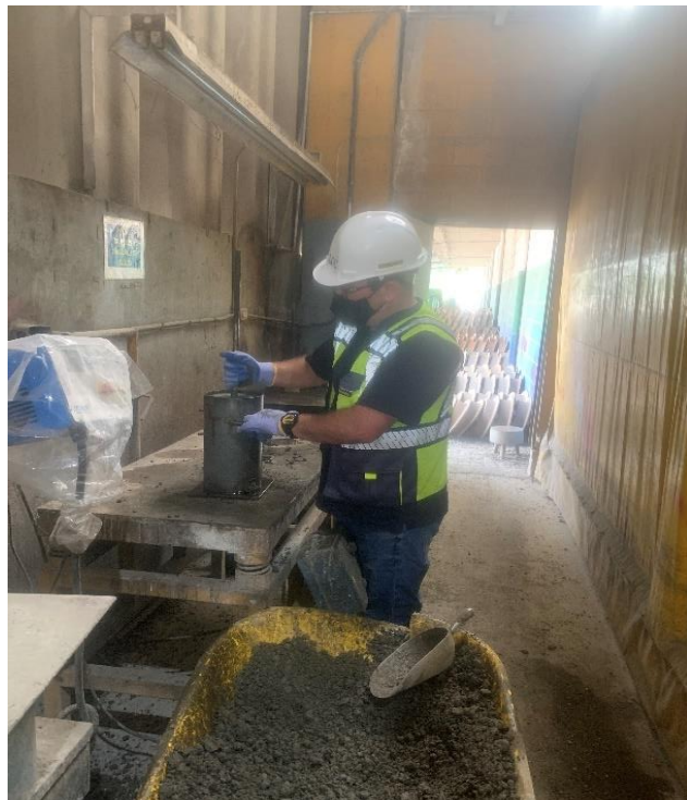
Moldeo de cilindros de concreto en mesa vibratoria
