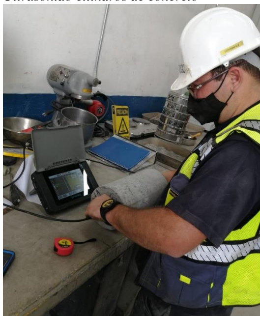
Ultrasonido cilindros de concreto
