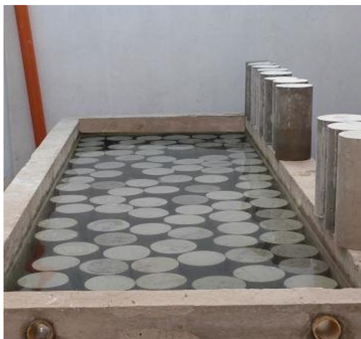
Cámara de curado de concreto
