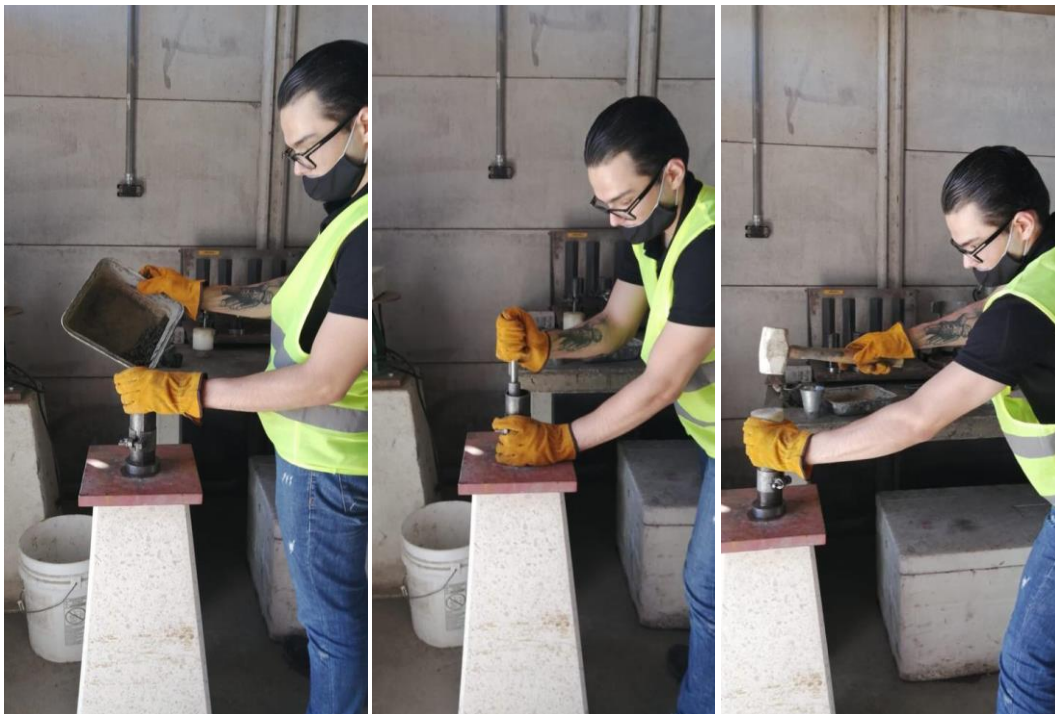
Figura 17 Moldeo de especímenes
