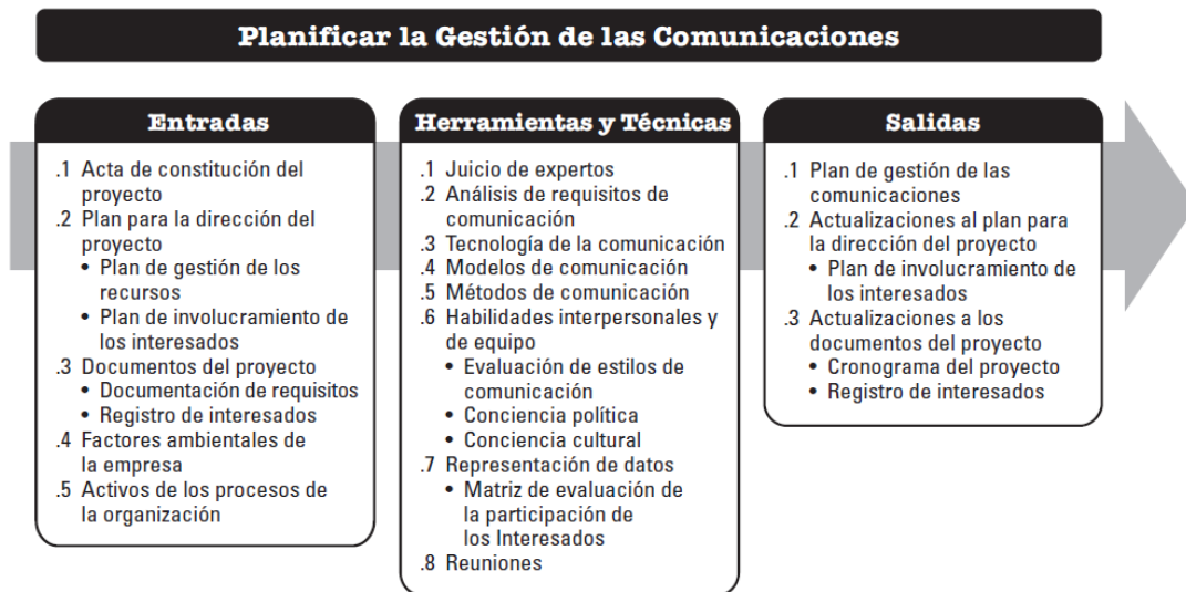
Gráfico 10-2. Planificar la Gestión de las Comunicaciones: Entradas, Herramientas y Técnicas, y Salidas
