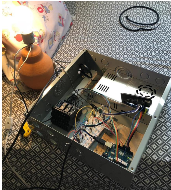
Figura 3.12. Prueba de funcionamiento de programaciones con lámpara de mesa 50W (Elaborado por Herrera, Daniel. 2018).
