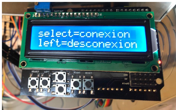
Figura 3.14. Pantalla LCD en funcionamiento y espera de ordenes (Elaborado por Herrera, Daniel. 2018).
