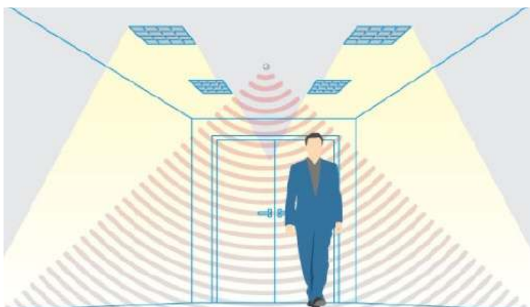
Figura 2.12: Detección por sensor con tecnología ultrasónica.
