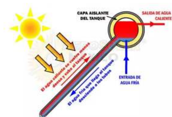
Figura 2.17: Funcionamiento de un calentador de agua.
