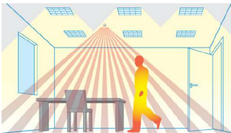
Figura 2.11: Detección por sensor con tecnología infrarrojo pasivo. Fuente: http://www.iluminatronics.com/funcionamiento-de-un-sensor/
